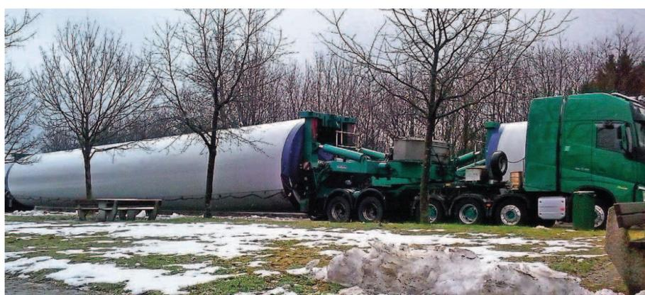
Die größten Transportzüge für die Windräder können bis zu 63 Meter lang sein. FOTO: HGN
